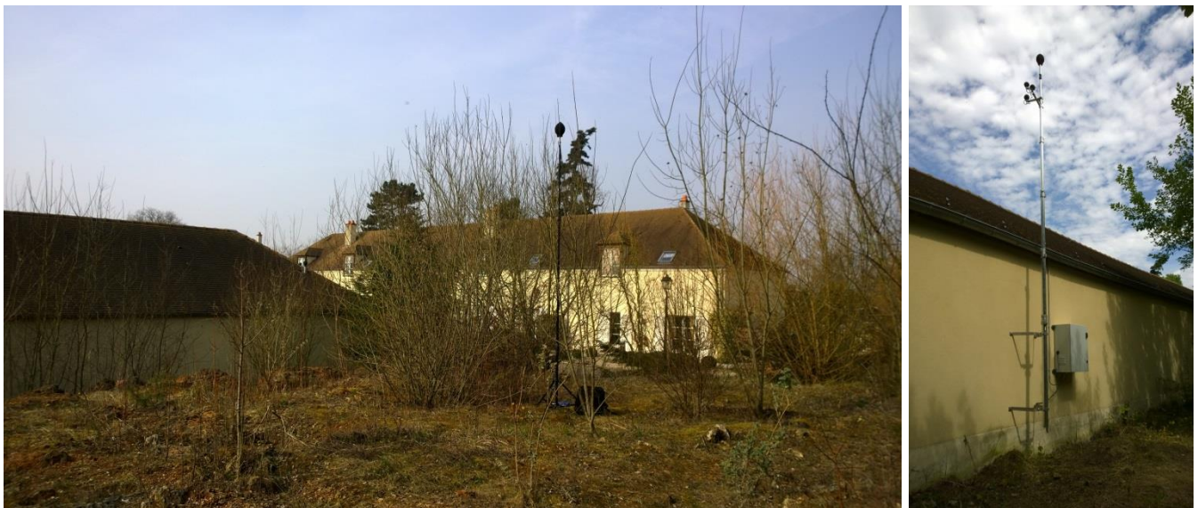
Figure 2 : à gauche : positionnement de la station de mesure du bruit en champ libre (configuration de la campagne de mesure du bruit 2011) ; à droite : positionnement de la station de mesure permanente (depuis 2015).
